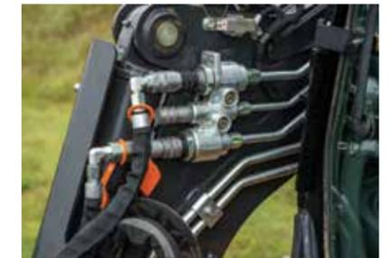
**STANDARD ENHANCED HIGH-FLOW AUXILIARY HYDRAULICS**
